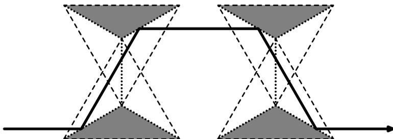
В качестве примера на рисунке жирной линией показан также один из лучей, проходящих через систему. Все отрезки этого луча между последовательными отражениями от зеркальных поверхностей призм составляют с этими зеркальными поверхностями углы  $30^\circ$ . Видно, что участки луча до и после прохождения системы зеркальных призм лежат на одной прямой, то есть система призм как бы не оказывает на это луч никакого влияния. То же самое произойдёт и со всеми другими лучами, имеющими то же направление.
